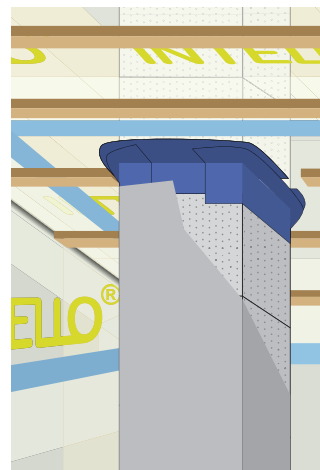
Hormia ympäröivä höyrynsulku tiivistetään hormiin Tescon No. 1 yleisteipillä.
